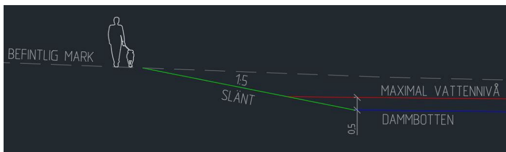
Figur 19: Principsektion dagvattendamm. Den totala släntutbredningen visas med grön skraffering och dammens bottenutbredning med blå skraffering. Den röda linjen beskriver konstruktionens högsta godtagbara nivå för vattenyta.
