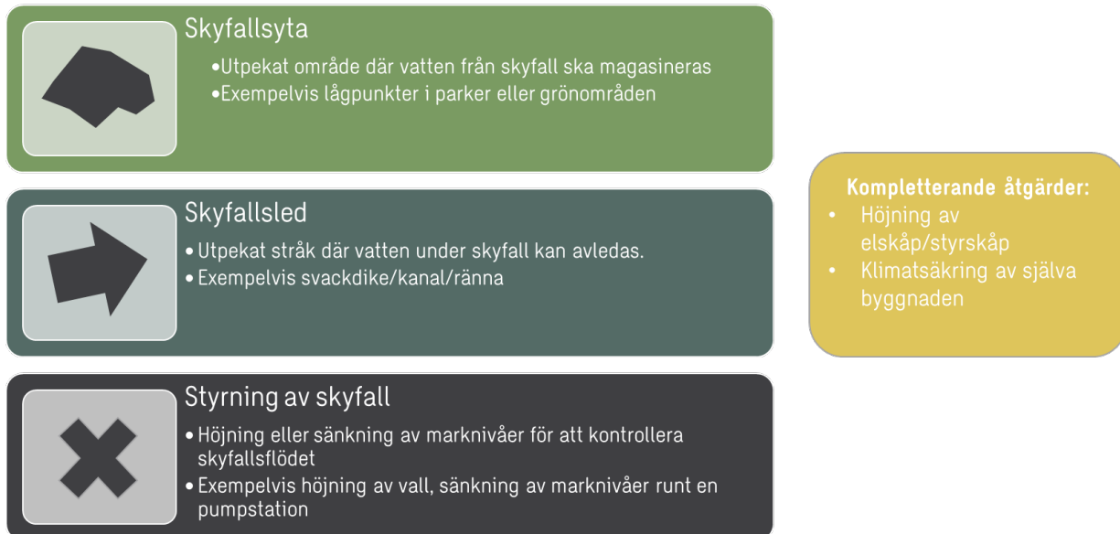
Figur 13. Schematisk illustration av tänkbara skyfallsåtgärder.
